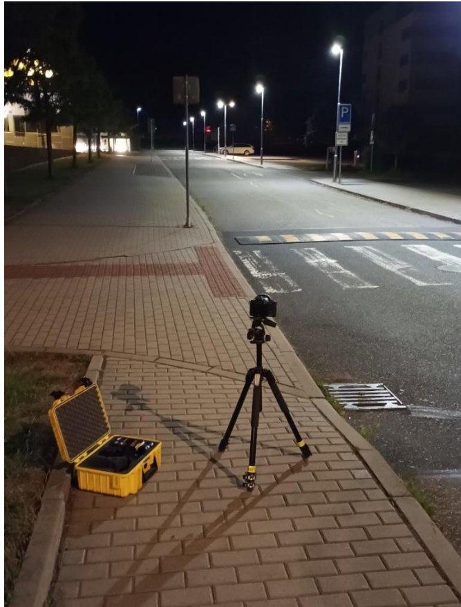
Obrázek 4-8 Měření jasů pomocí jasového analyzátoru LumiDISP
