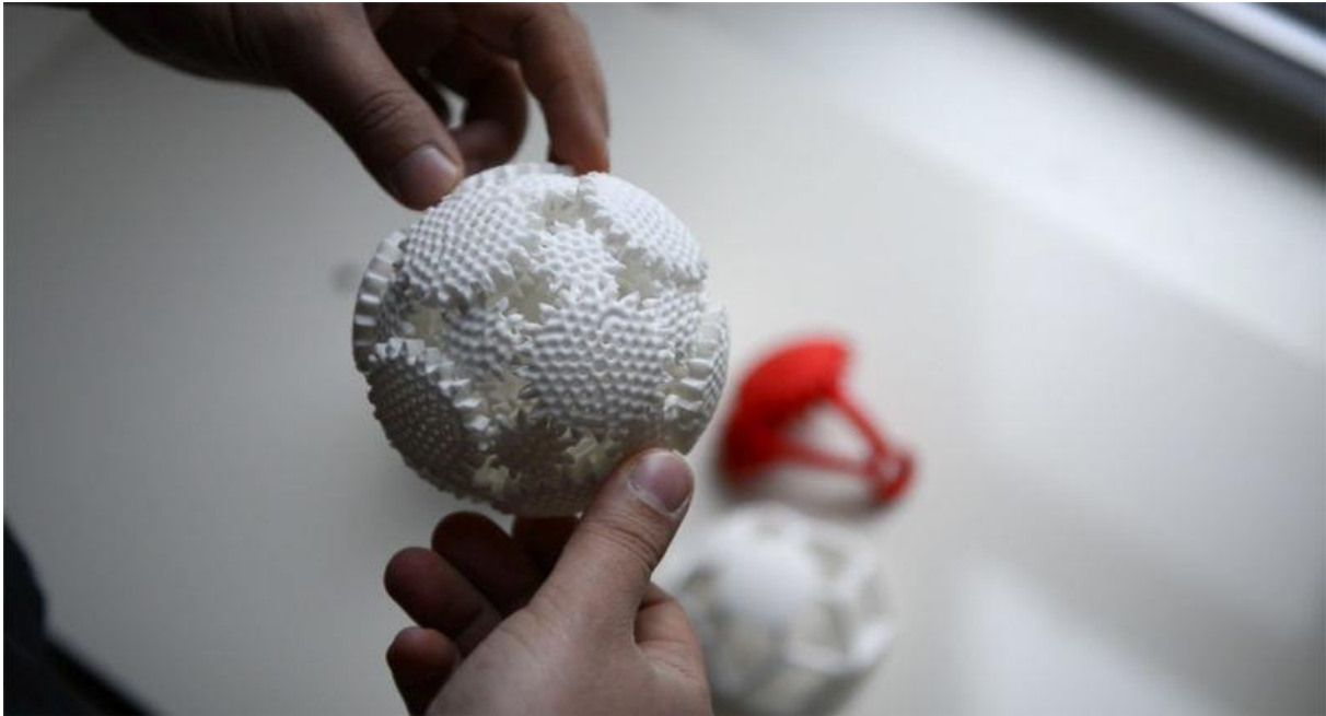
Obr. 7) Pohyblivá soustava vytištěná metodou FDM [9]
