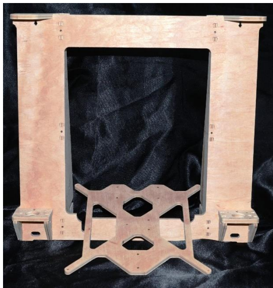
Obr. 9) Rám z překližky na 3D tiskárnu Průša i3 [11]
