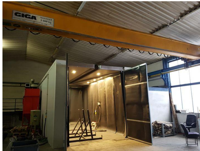
Obr. 2 Zařízení na tryskání ocelových konstrukcí (Zdroj: PKD, sro, 2018)
