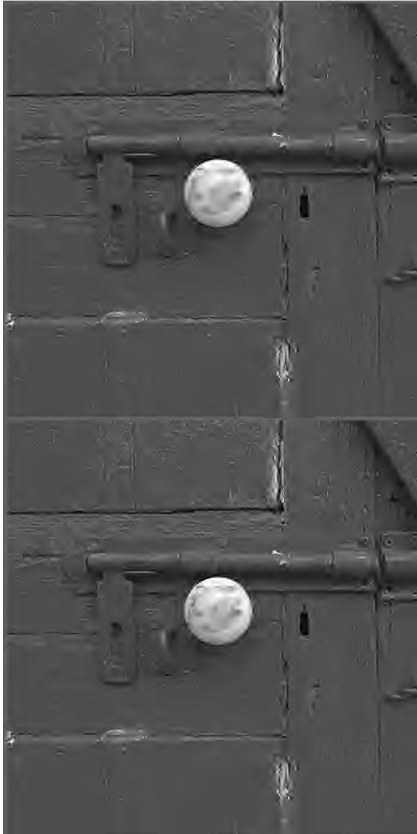
Obr. A.3: Obrázek kodak02.bmp pro \text{bpp}=0,125 při rovnoměrném rozdělení bitů (nahore, \text{MSSIM}=0,7325 ) a rozdělení podle kombinované metody pro \alpha=0,7 (dole, \text{MSSIM}=0,7399 ). Hodnoty \text{MSSIM} se vztahují k původnímu obrázku (obr. 5.6).
