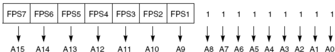
Obr. 4: Mechanismus blokové ochrany [3]
