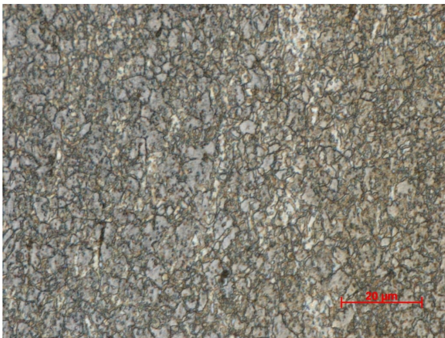
Obrázek 4: Mikrostruktura hořčíkové slitiny AZ61, příčný směr, leptadlo pikral [12], zvětšení 1250×
