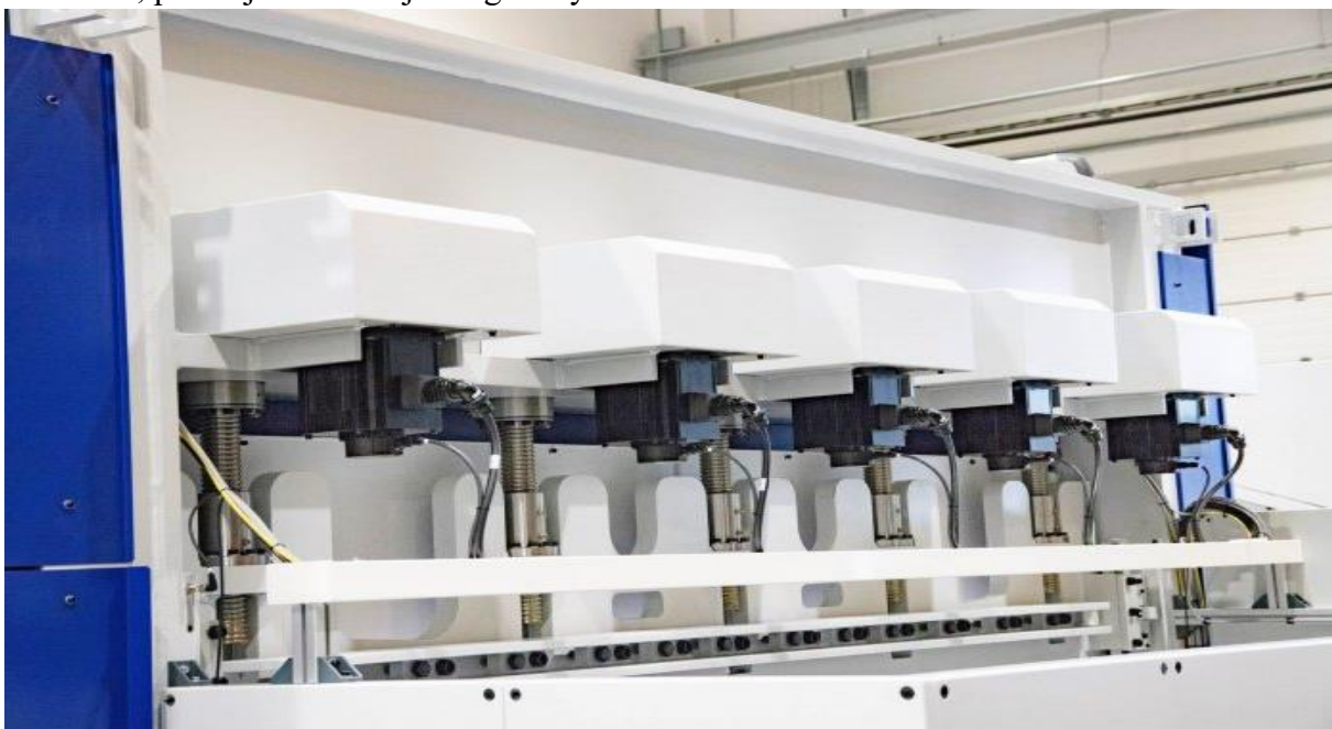
Obr. 19 Ohraňovací lis s pohybom barana realizovanom guľôčkovými skrutkami [26]
