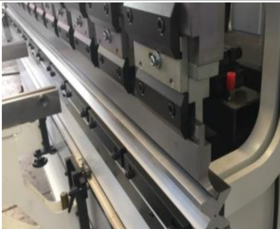
Obr. 14 Ukážka mechanického upnutia razníka aj matrice [16]
