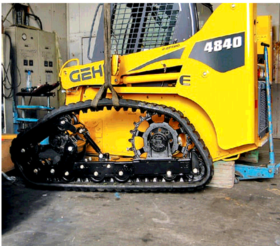
Obr. 27: Montáž podvozku na nakladač [3]
