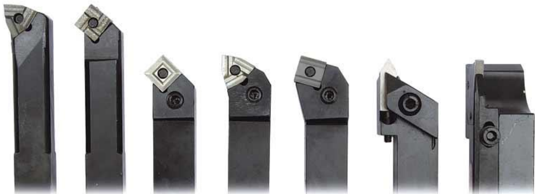
Obr.12 Některé druhy soustružnických nožů s vyměnitelnými břity [7]
