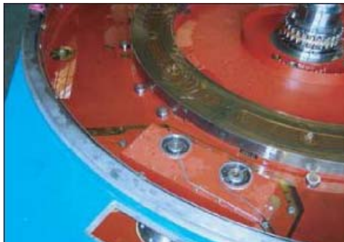
Obr.18 Hydrostatické ložisko stroje řady SKG [2]
