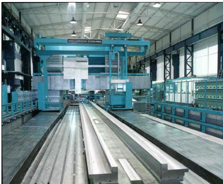
Obr.26 Portálová vertikální frézka [11]
