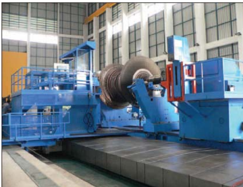
Obr.13 Horizontální hrotový soustruh ŠKODA SR [22]
