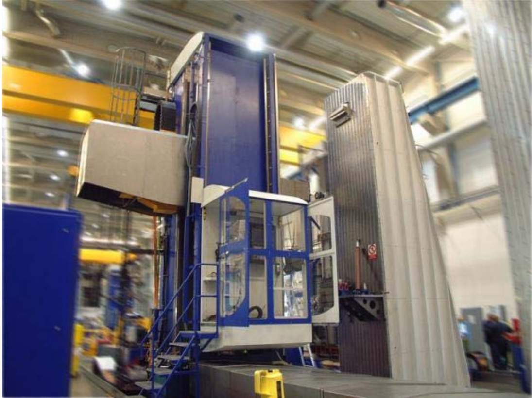
Obr.24 Desková horizontální vyvrtávačka WRD 170(Q) [20]
