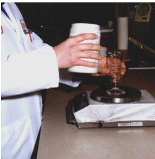
Obr. 40 Kontrola měrné hmotnosti [41]
