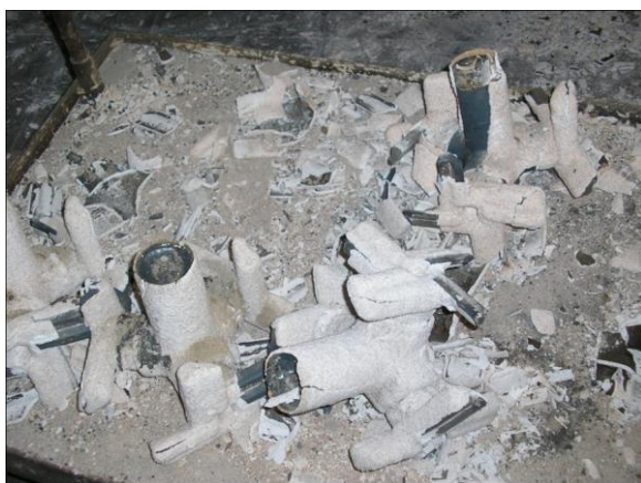
Obr. 52 Hrubé odstranění keramiky [34]
