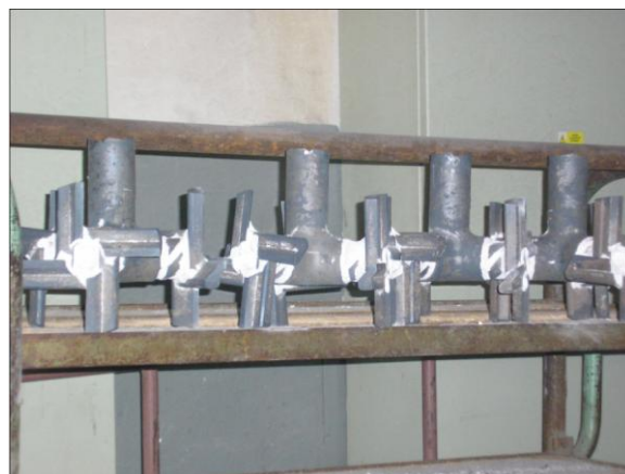
Obr. 52 Hrubé odstranění keramiky [34]
