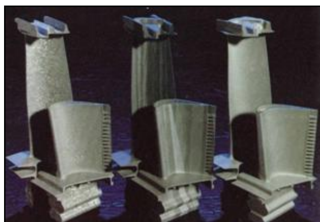
Obr. 3 Lopatka leteckého motoru - rovnoosá struktura, usměrněná krystalizace, monokrystal [10]
