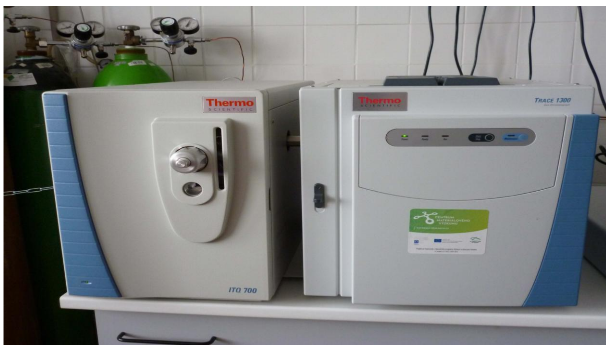
Obrázek č. 35: Plynový chromatogram Thermo Trace 1300 s hmotnostním detektorem ITQ 700 se sférickou iontovou pastí
