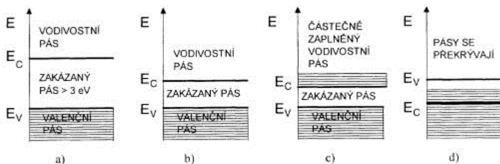
Obrázek 3 Na obrázku je vidět pásová struktura a) izolantu b) polovodiče c) monovalentního kovu d) bivalentního kovu.
