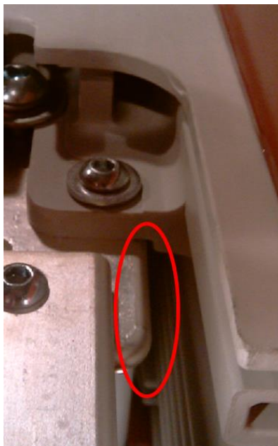
Obr. 52 Kritické miesto na hornom držiaku vypínača ABB Vmax
