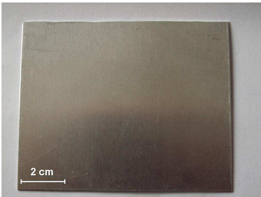
Obrázek 9: Původní stav plechu Al 2024-T61 s hliníkovým povlakem.
