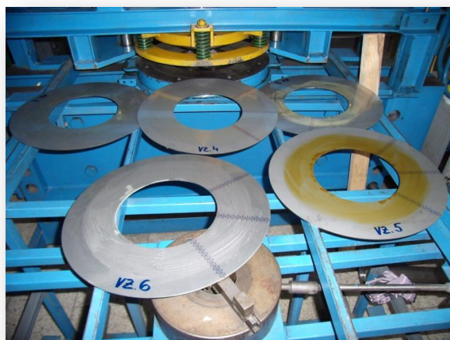
Obr.7.4 Vzorky s nanесeným mazivem
