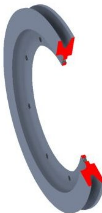
Obr. 3.7 Řez věncem řemenice.
