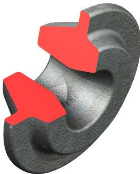
Obr. 3.4 Řez odlitkem náboje řemenice.
