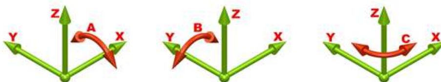
Obr. 1.2 Translační osy X, Y, Z a rotační osy A, B, C [4].
