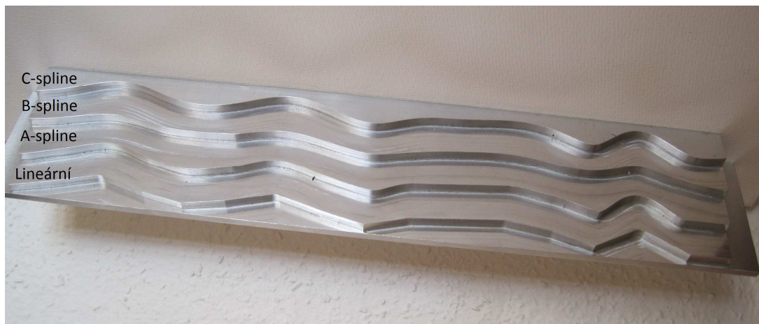
Obr. 3.3 Finální obrobek, postupně: lineární trajektorie, A-spline, B-spline, C-spline.
