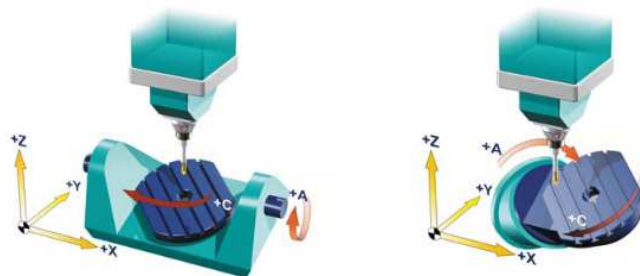
Obr. 1.3 Kinematický princip obráběcího centra - rotační osy ve stole [4].
