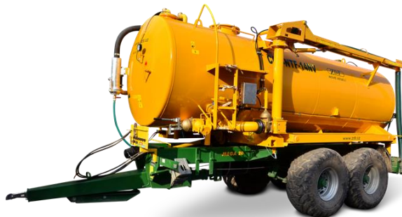
Obrázek č. 4: Cisterna NTF 14 (Zdroj: 24)
