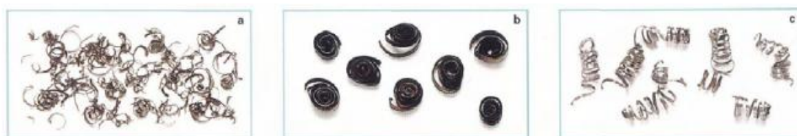
Obr. 3.1 Tvary třísek při řezání pásovou pilou [5]:
