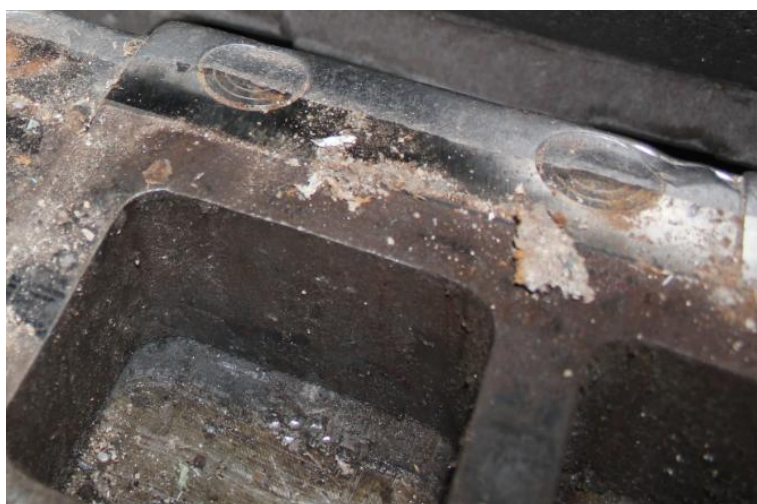
Obr. 1.7 Opatřebený nůž na statoru.
