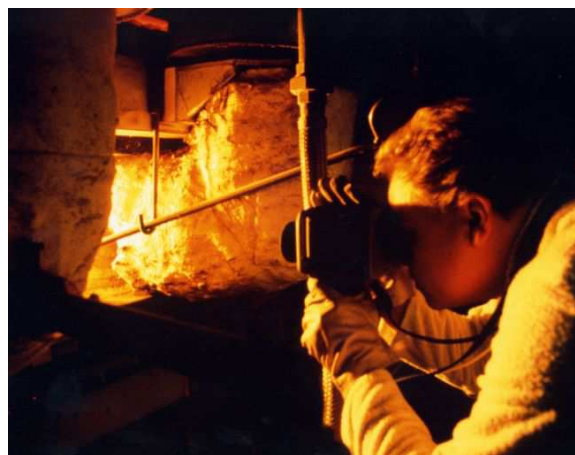
Obr. 2 Ukázky bezdotykového měření teplot pomocí termovize a pyrometru [19,18]
