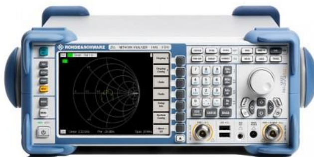
Obr. 1.1: Vektorový obvodový analyzátor R&S ZVL-6 [20]
