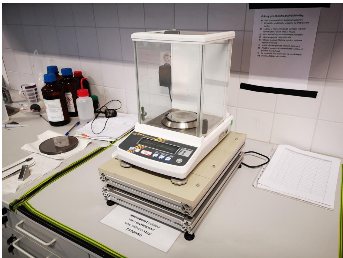
Obr. 5-15 Finální verze antivibrační platformy
