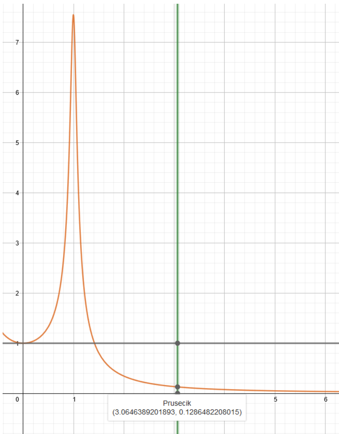
Obr. 5-9 Nalezení průsečíku přenosové křivky a poměru frekvencí
