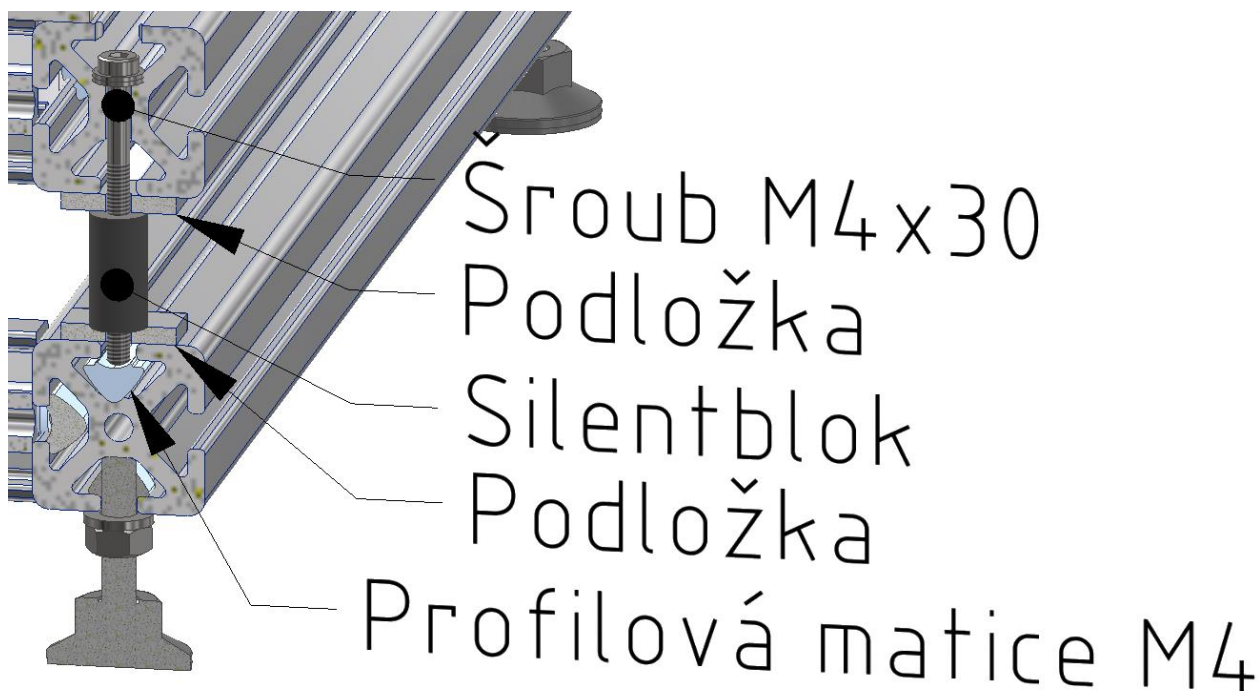
Obr. 5-11 Uložení silentbloků na platformě
