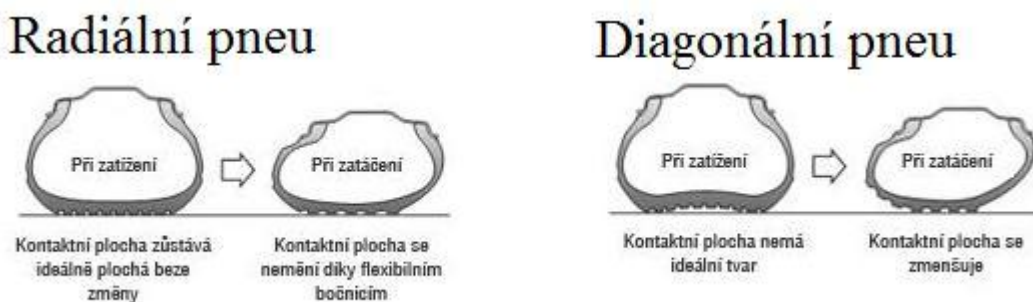
Obrázek 1-6: Rozdíl ve velikosti stykových ploch a v deformacích pro radiální a diagonální pneumatiky při zatížení a při zatáčení.[9]
