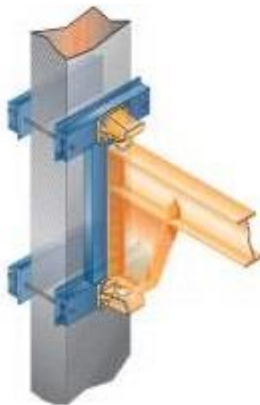
Obr. 3. 1 Upevnění na železobetonových podpěrách pomocí konzoly [10]
