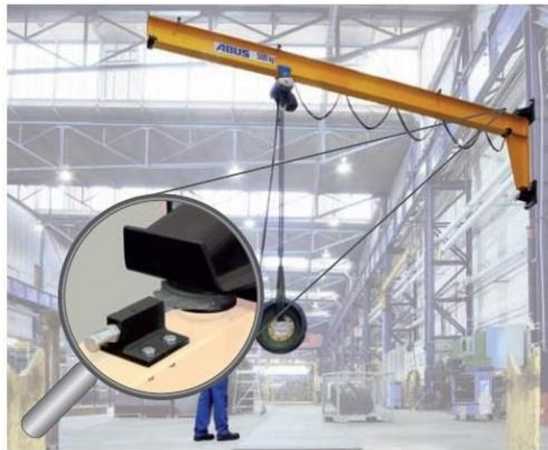
Obr. 5. 1 Regulace odporu otáčení - řešení od firmy ABUS [10]
