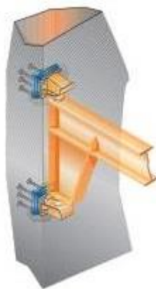
Obr. 3. 2 Upevnění na železobetonových stěnách pomocí přivařovacích desek [10]
