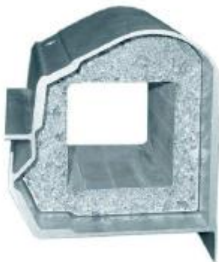
Obr. 5 Výztuha prahů automobilů Ferrari z pěnového hliníku ALULIGHT [11]
