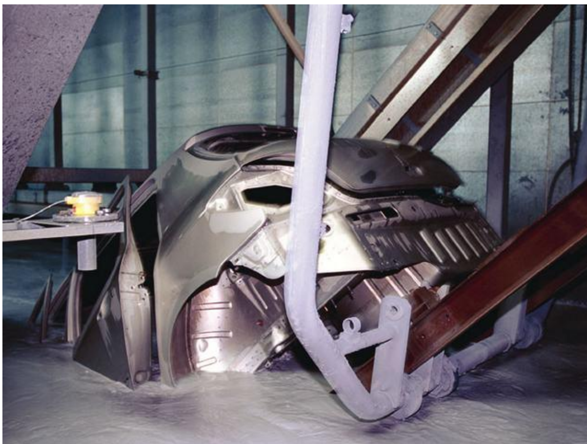
Obr. 9 Ponoření karoserie do lakovací lázně (katakforéza) [19]
