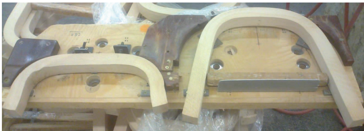
Obr. 18 Umístění ohybů na základacím přípravku.
