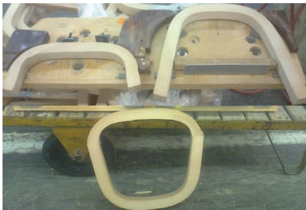
Obr. 14 Ustavení a spojení dvou ohybů.
