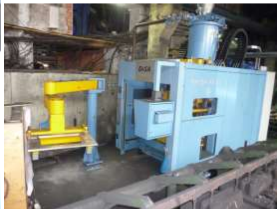
Obr. 14 celkový pohled na formovací stroj
