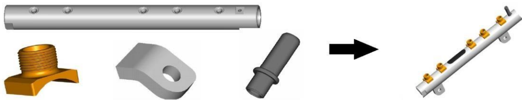
Obr. 3.4 Zleva: rail před navařením komponentů, kompletní rail [1].
