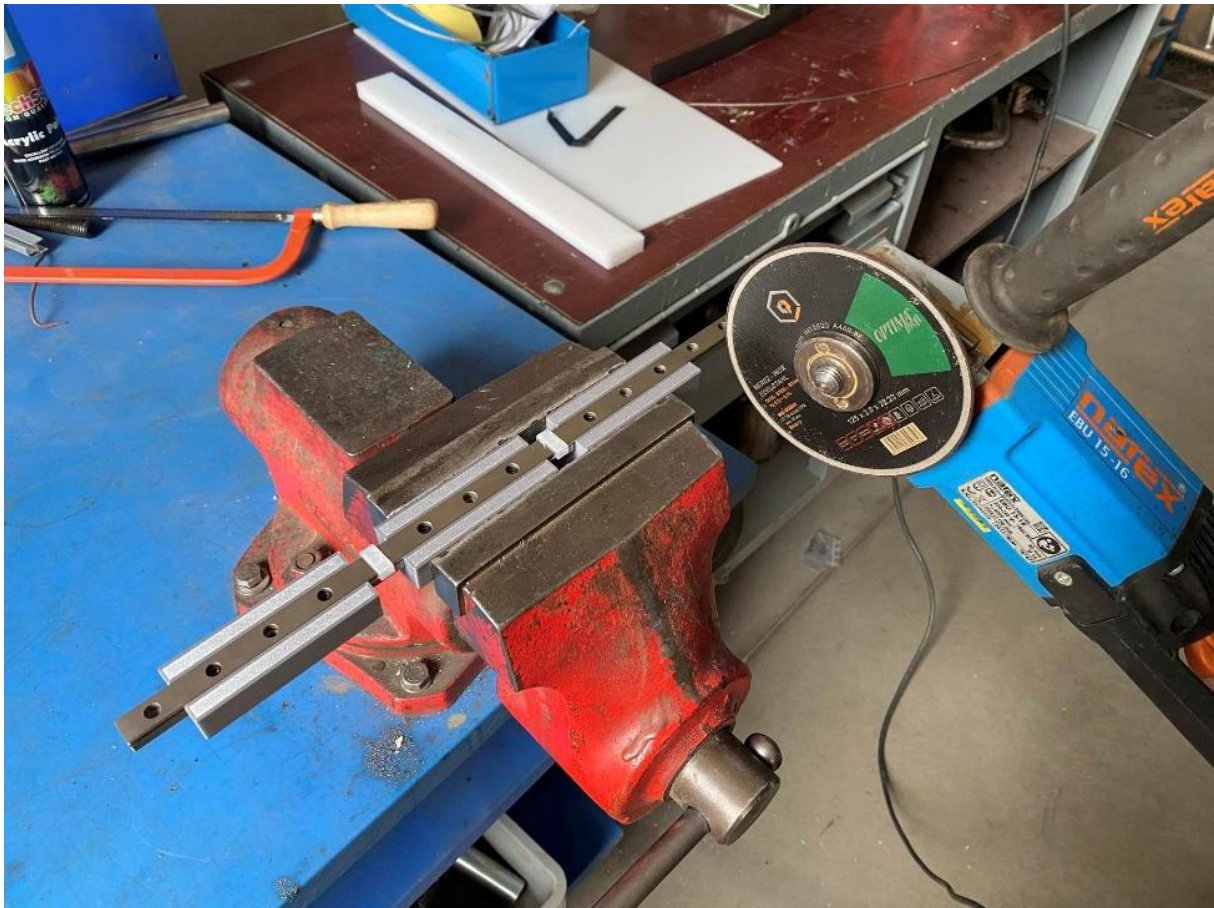
Obr. 31 Kolejnice v přípravcích pro přesné dělení a upevnění do svěráku
