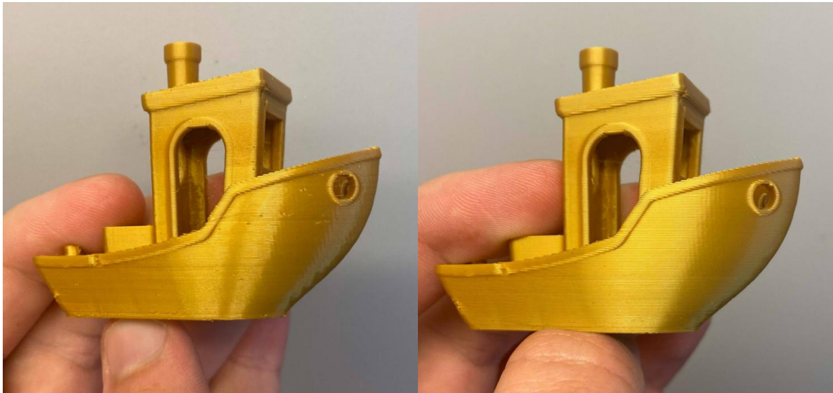
Obr. 37 lodička 3Dbenchy, vlevo tisknuta na původní verzi tiskárny, vpravo na modifikované
