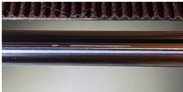
Obr. 23 Opotřebená hlazená ocelová tyč 3D tiskárny Průša MK4
