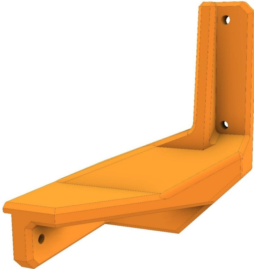
Obr. 30 Dodatečný spoj pro zvýšení tuhosti tiskárny
