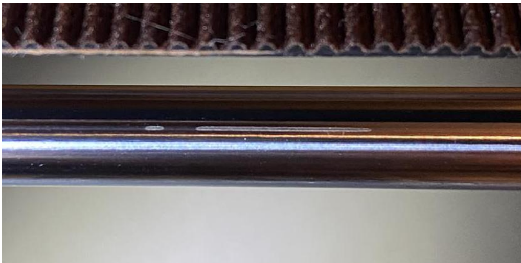
Obr. 21 Opotřebovaná ocelová tyč lineárního vedení 3D tiskárny Prusa Mini
