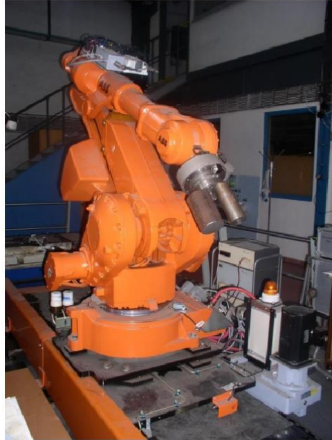
Obr. 12) Průmyslový robot ABB IRB 4400/60 na VUT v Brně [13]
