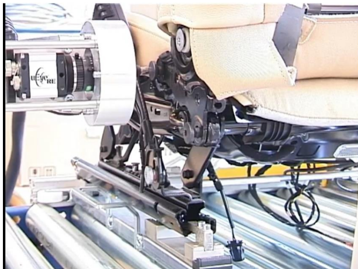
Obr. 15) Kobot UR16e vykonávající montážní činnost [16]
