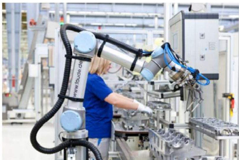
Obr. 18) Kobot ve velkosériové výrobní lince pro výrobu motorů Volkswagen [19]
