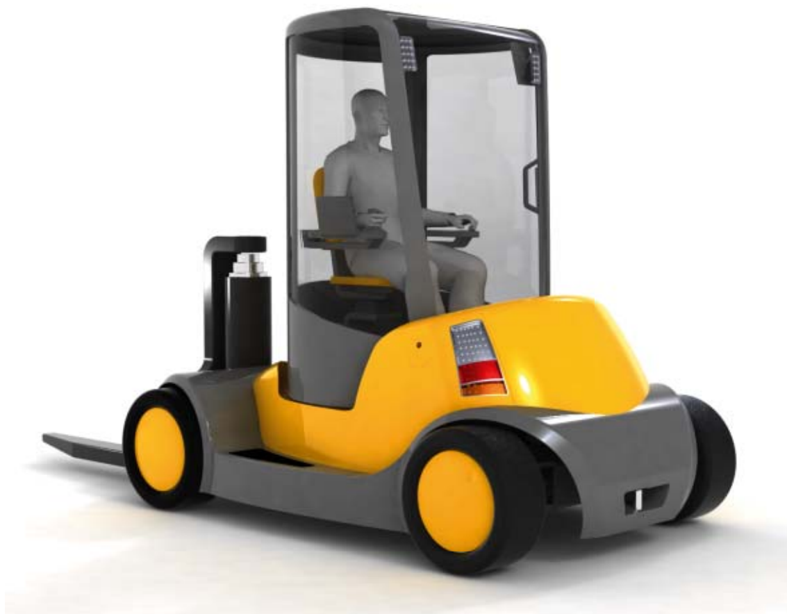
Obr. 5.11: Otočená kabina – celkový pohled
