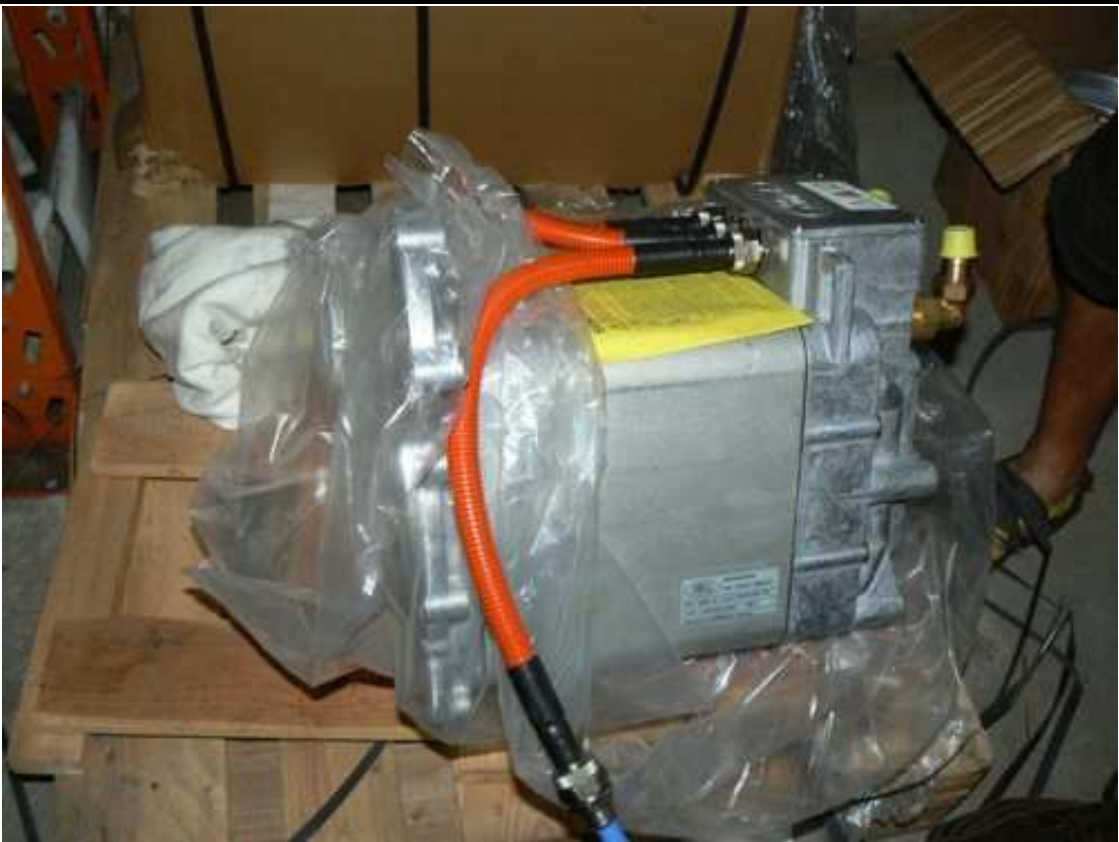
Obr. 24 Vodou chlazený střídavý asynchronní elektromotor [19]
