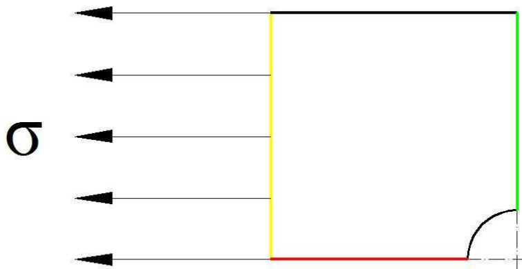
Obr. 2 Čtvrtina součásti s barevným vyznačením okrajových podmínek
