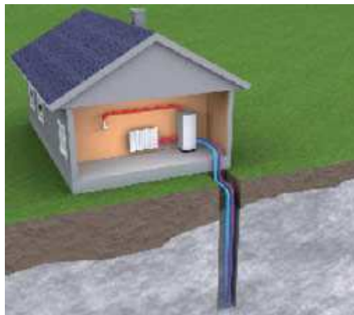
Obr. 6.3.2 Schéma zapojení tepelného čerpadla pro zemní vrtý[22]
