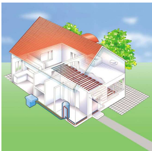
Obr. 6.1.1 Schéma zapojení tepelného čerpadla vzduch-voda [17]
