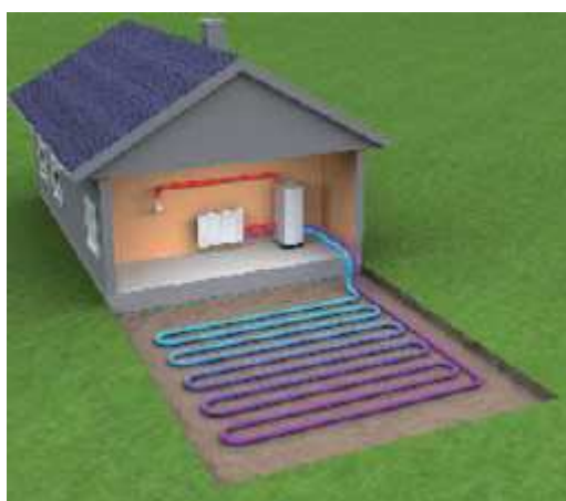
Obr. 6.3.1 Schéma zapojení tepelného čerpadla pro zemní kolektory[21]
