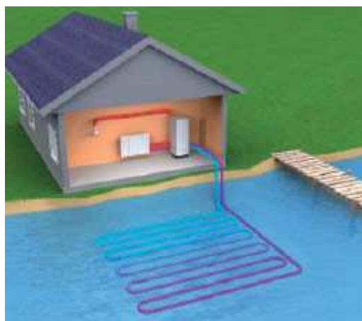
Obr. 6.2.3 Schéma instalace tepelného čerpadla pro povrchovou vodu[20]
