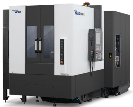
Obr. 2 - 20 CNC vysokorychlostní horizontální centrum HS4000II [14]
