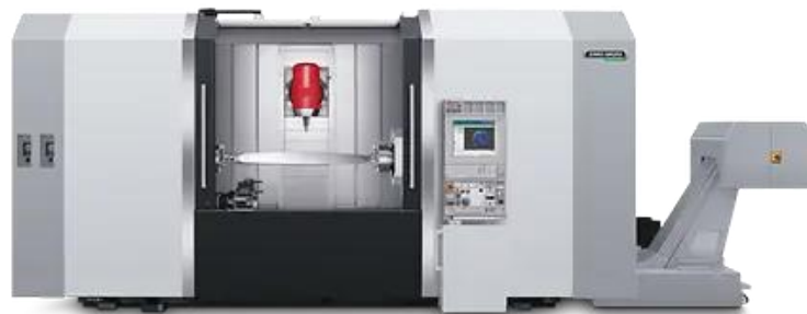
Obr. 2 - 22 Pěti-osé obráběcí centrum NT 4200 DCG [15]
