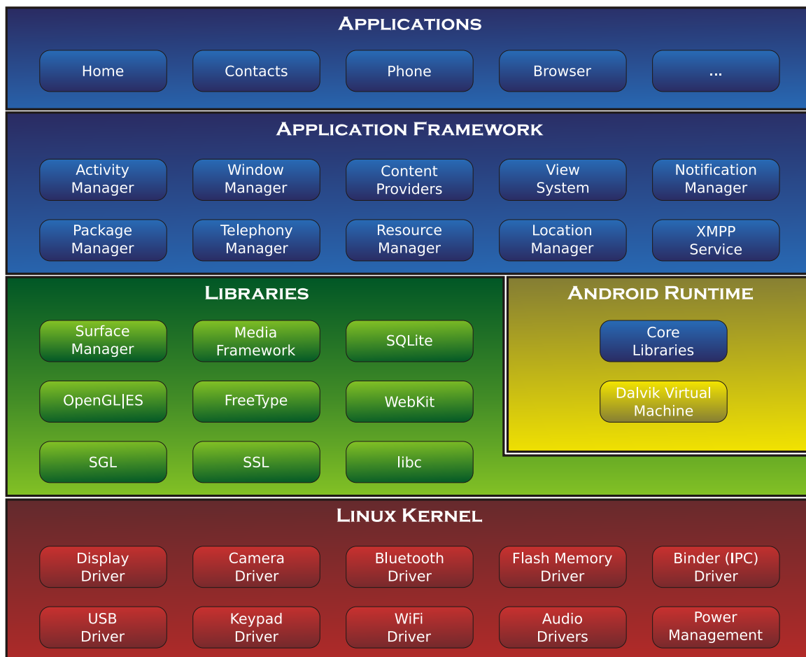
Obrázek 3.1: Vrstvy OS Android. Zdroj: [5]
