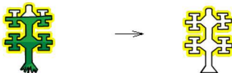
Obr. 2.5 Vytavení voskového modelu. [3]
