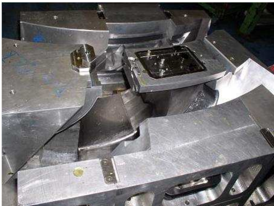
Obr. 2.1 Forma s výsuvnými částmi vyrobená obráběním. [3]
