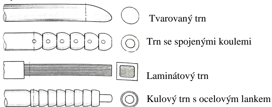
Obr. 30 Příklady různých tvarů trnů [7]
