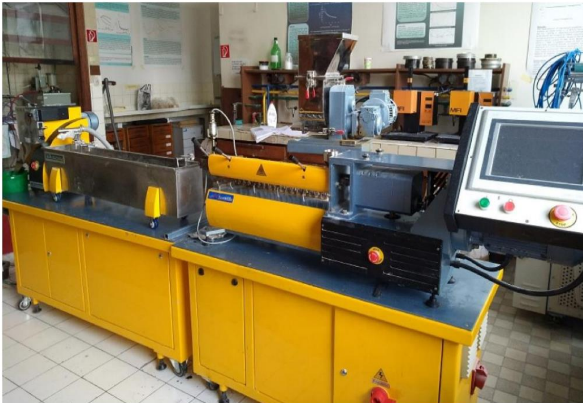
Obr. 19: Laboratorní dvoušnekový extruder LabTech Engineering, pracoviště STU
