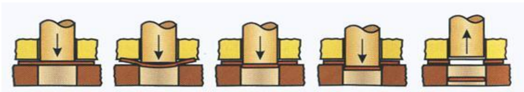
Obr. 2.2 Princip stříhání pomocí stříhadla [11]
