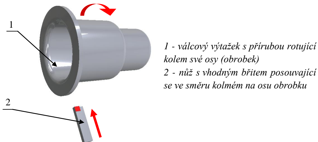
Obr. 2.9 Princip radiálního soustružení příruby výtažku [10]
