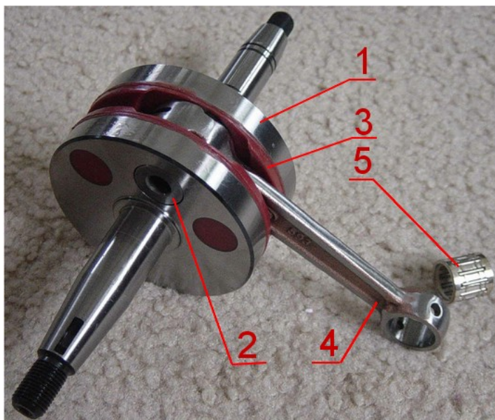
Obr. 1-1 Složený klikový hřídel dvoudobého motoru
