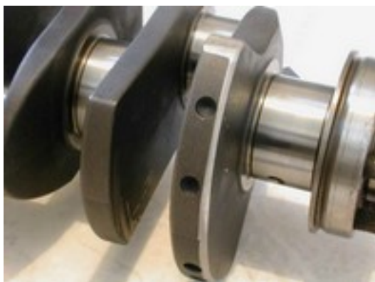
Obr. 1-3 Odvrtání na obvodu protizávaží [6]
