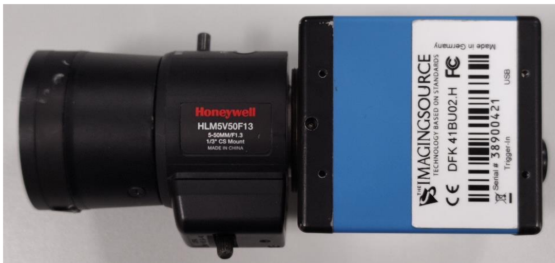
Obrázek 3.8 Boční kamera DFK 41BU02.H s objektivem HLM5V50F13
