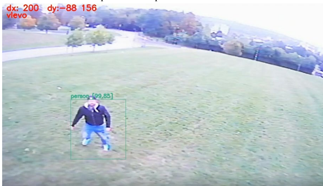
Obrázek 4.8 Test autonomního řízení dronu v definované vzdálenosti od cíle
