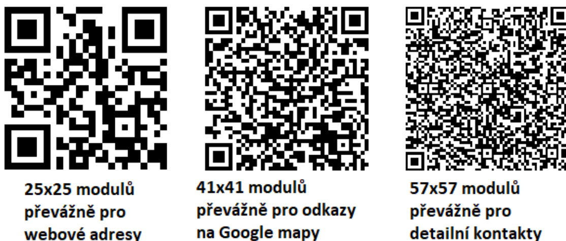
Obrázek 1.7 Velikosti modulů QR kódů zleva: 25x25 modulů, 41x41 modulů, 57x57 modulů [16]
