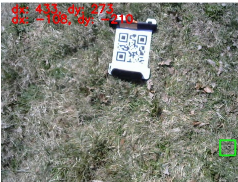
Obrázek 4.4 Příklad chybné detekce QR kódu
