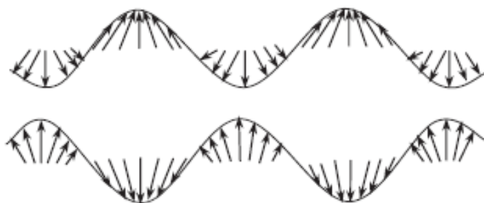
Obr. 2.2 Symetrický mód Lambova vlnění [7]
