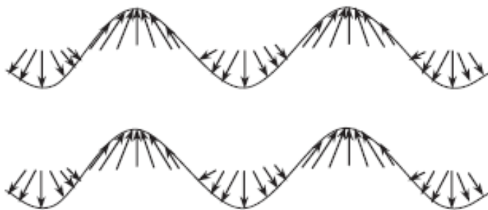
Obr. 2.3 Antisymetrický mód Lambova vlnění [7]
