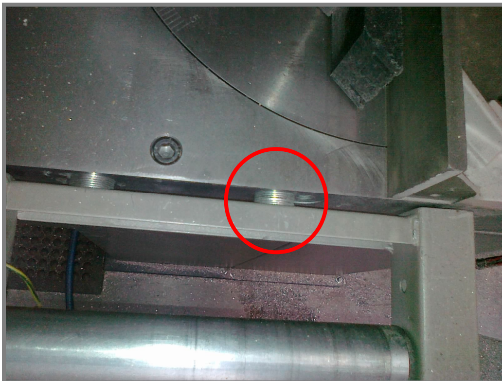
Obr. 2-5 Kotvení původního dopravníku k pile
