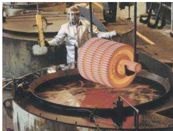
Obr.5.11 Ukázka chemicko-tepelného zpracování ozubených kol [20]
