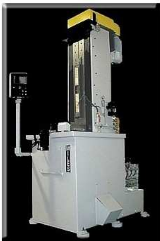
Obr.2.18 Ukázka svislého protahovacího stroje [17] + schéma [6]
