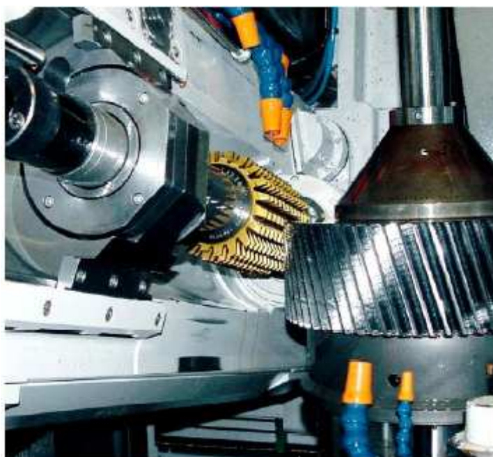
Obr. 2.22 Odvalovací způsob obrábění [27]
