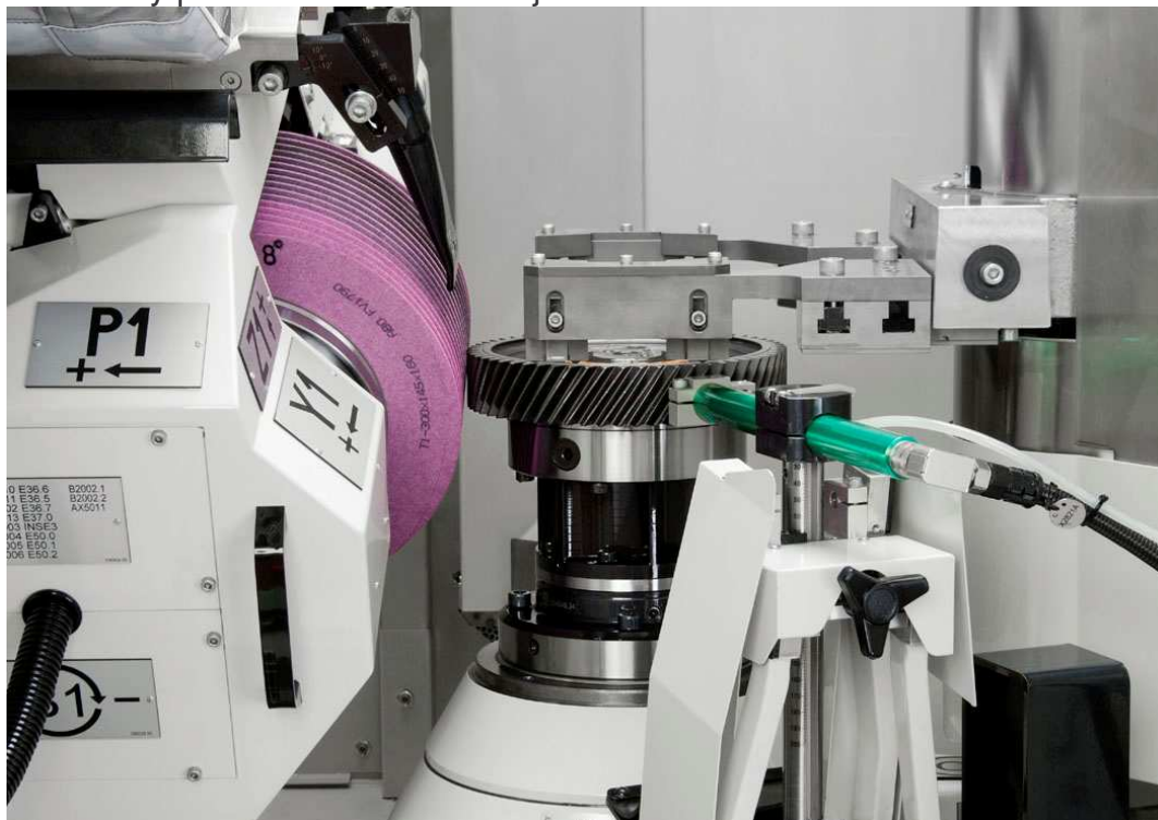
Obr.2.47 Broušení šikmého ozubení brusným kotoučem ve tvaru závitu [15]
