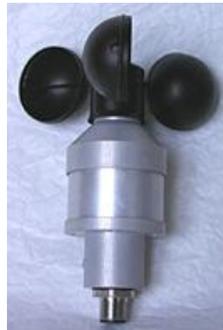
Obrázek 3.2: Tří-miskový anemometr. Převzato z [3]
