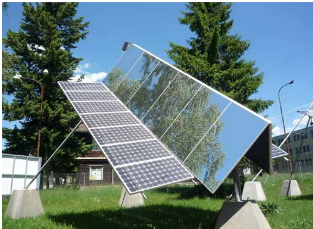
Obr. 21: Koncentrátory - zrcadlové panely, které sledují slunce [44]
