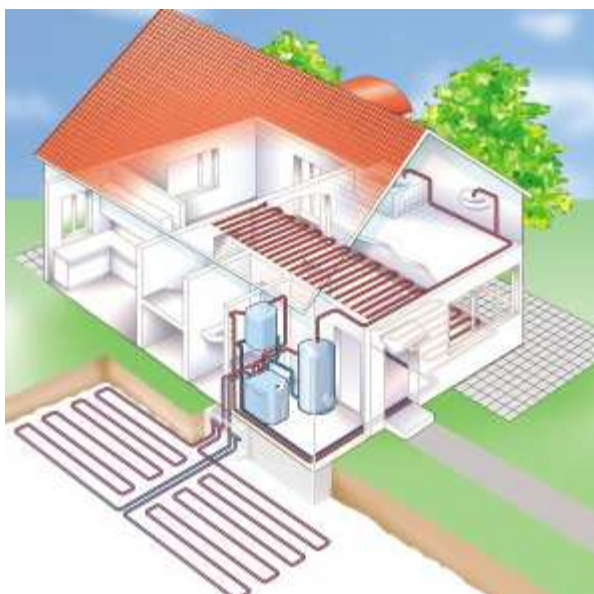
Obr. 18: Schéma využití tepelného čerpadla pro rodinný dům [39]
