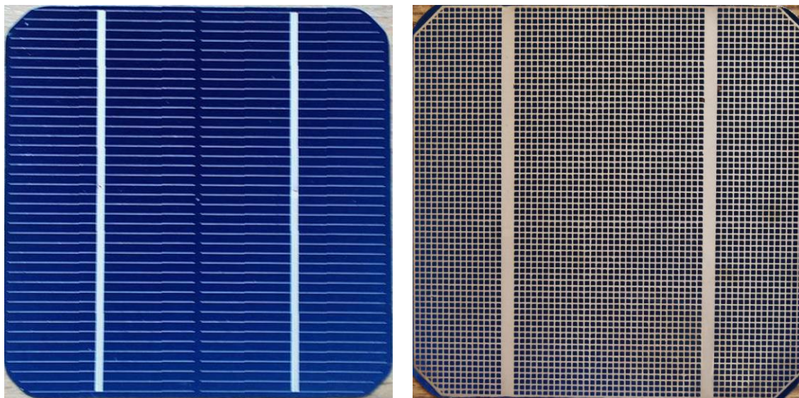
Obr. 7 Monokrystalický křemíkový solární článek (přední a zadní strana)
