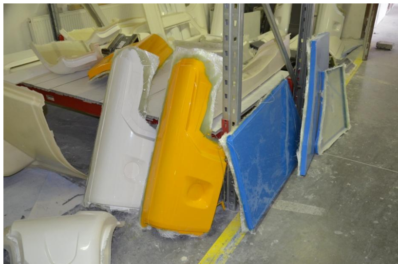
Obr. 3.1.1 Ukázka probarvení gelcoatu u hotových výrobků
