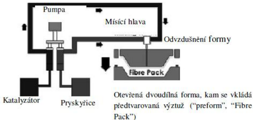
Obr. 1.15 Schéma výroby RTM [11]
