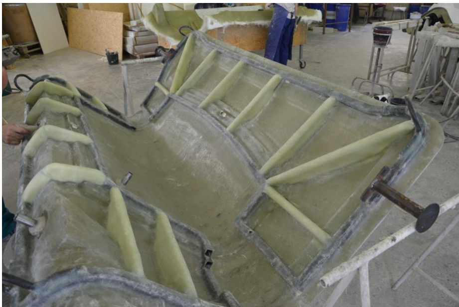
Obr. 3.4 Přelaminované výztuže formy
