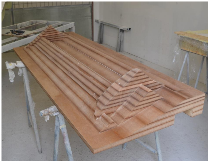
Obr. 3.1 Model vyfrézovaný do lepených MDF desek
