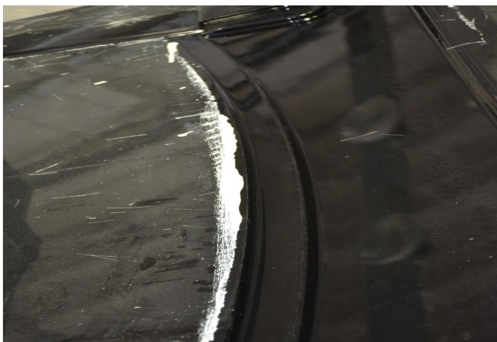
Obr. 3.7 Znečištění formy po laminaci
