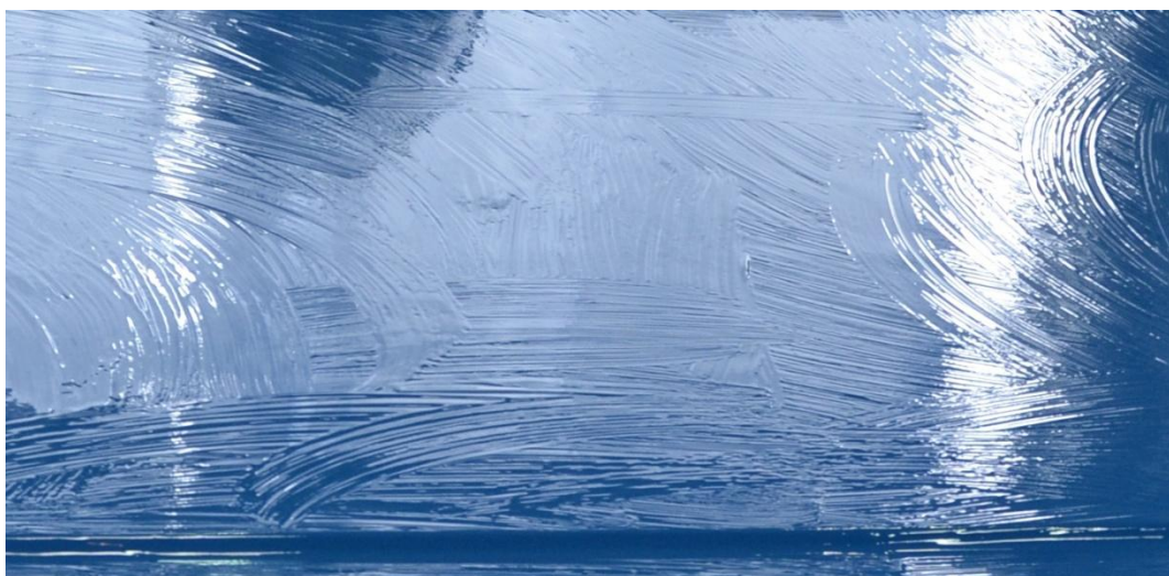
Obr. 3.5 Tahy štětce vzniklé v gelcoatu při jeho aplikaci
