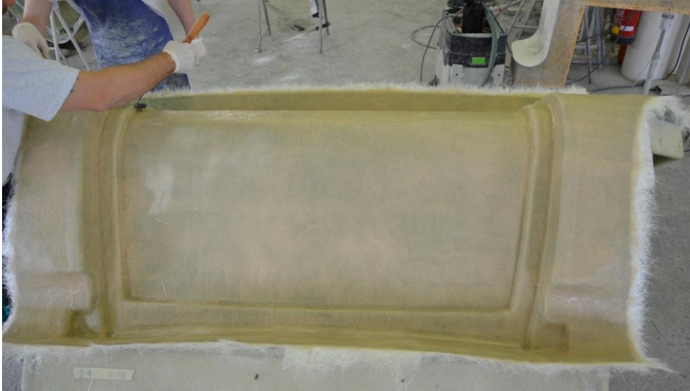
Obr. 3.3 Laminace nosné vrstvy
