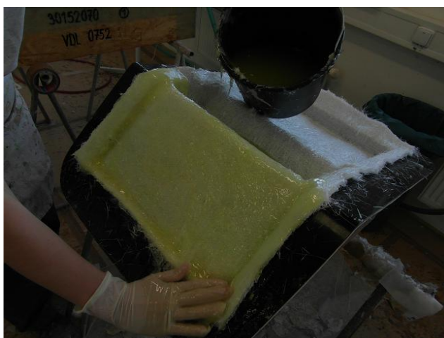
Obr. 1.17 Ruční aplikace pryskyřice [13]
